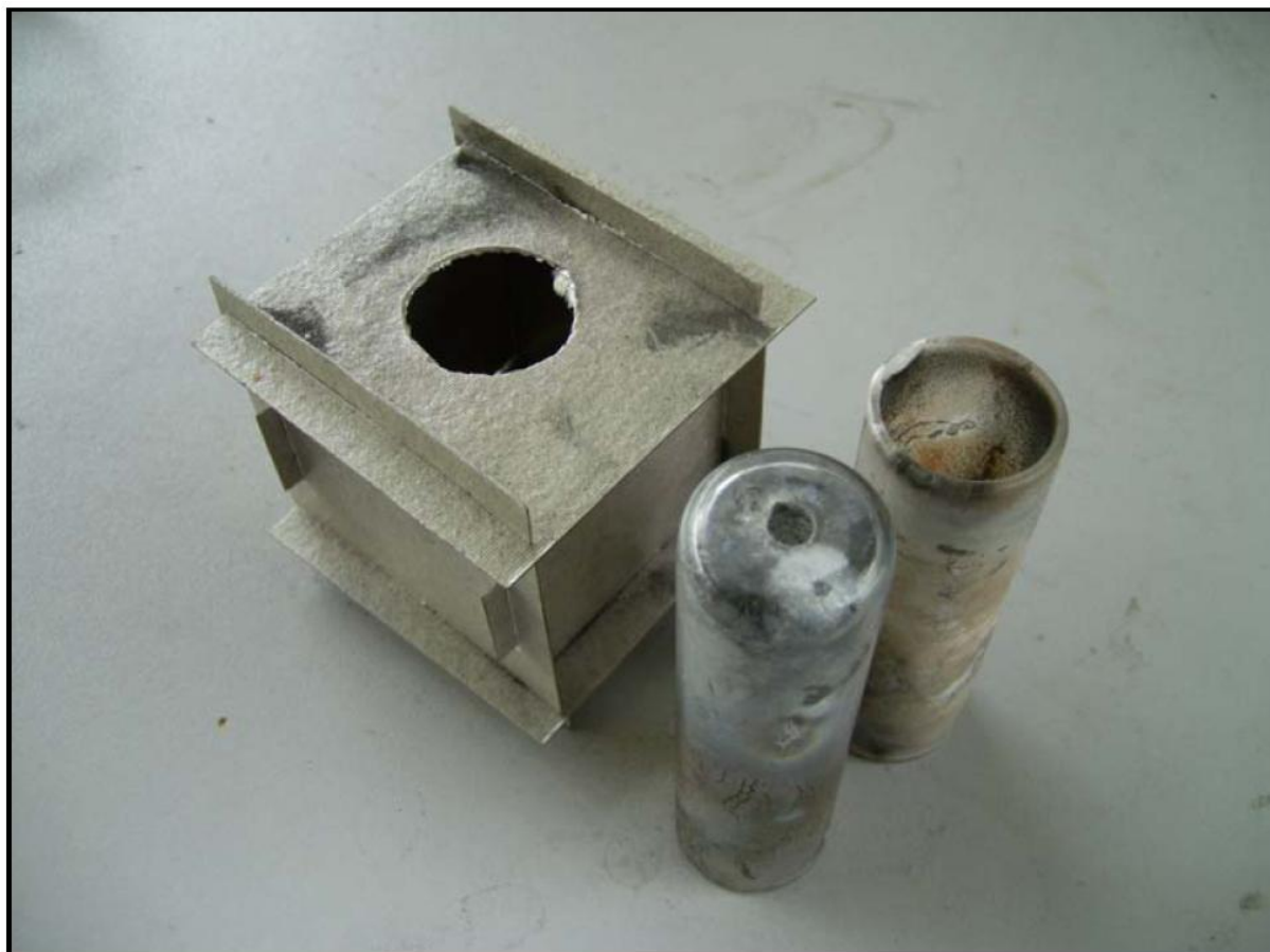
Foto1: Provizorní rezonátory: slídový box, trubicové skleněné rezonátory: půlvlnový, když jsou oba konce otevřené, čtvrtvlnový, když je jeden konec uzavřen.
