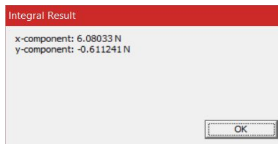
Obr. 4: Síla působící na prstenec se dvěma magnety
