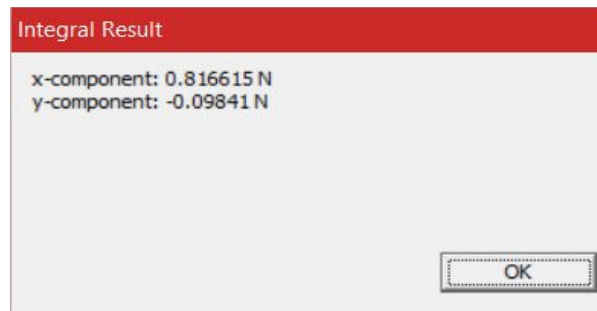
Obr. 6: Síla působící na železnou krychli
