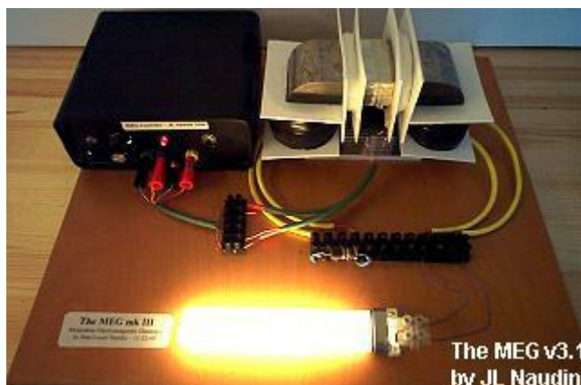
Obr. 1: MEG s nelineární zátěží v podobě kompaktní zářivky
