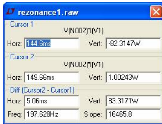
Obr. 7: Příkon motoru v rezonančním režimu
