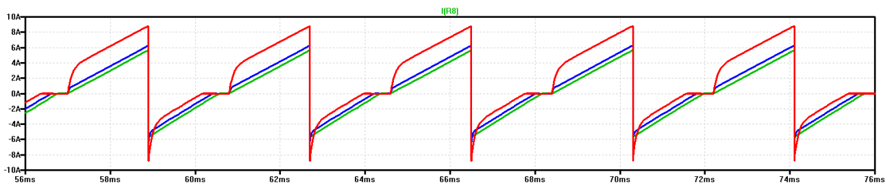
Obr. 2: Závislost odběru proudu na velikosti zátěže
